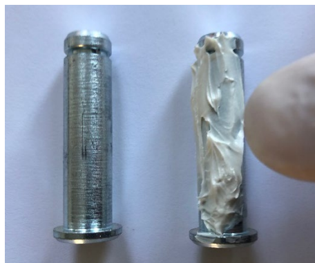
Påføring af fedt på bolt
