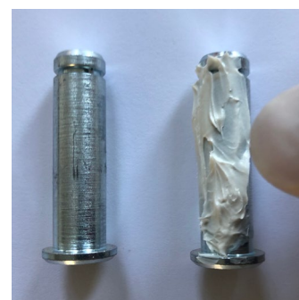
Påføring af fedt på bolt
