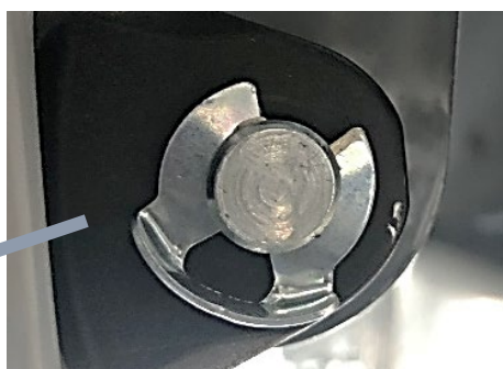
Clips i modsatte ende af motoren
